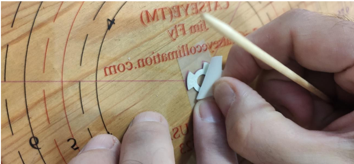
Preparación en una plantilla para instalar la nueva pegatina de colimación en el espejo primario.
