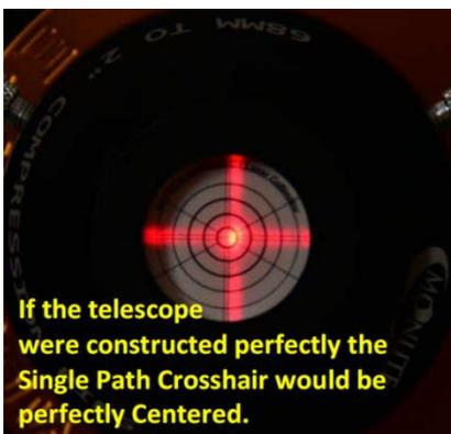
Si el telescopio hubiera sido construido perfectamente, la cruceta láser de paso único estaría perfectamente centrada.
